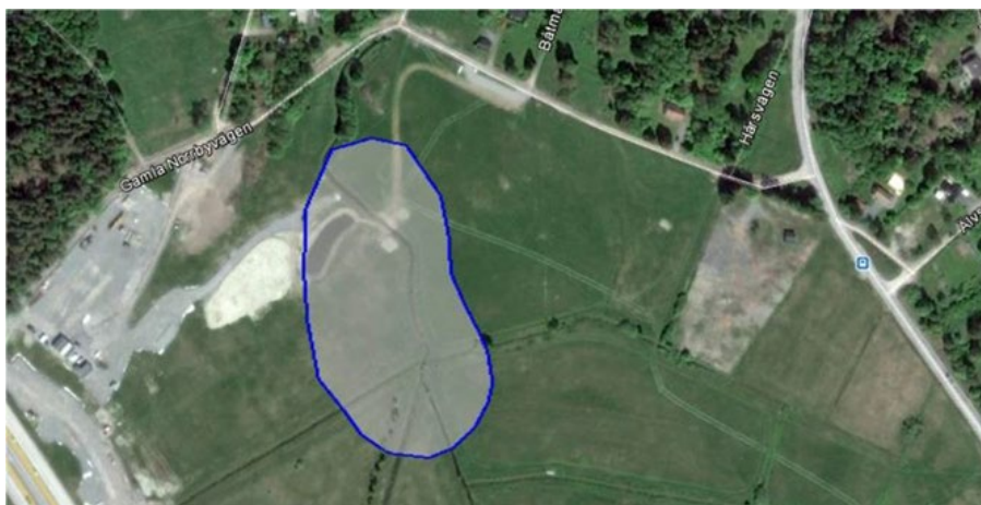
Figur 3. Illustration av ytbehov och ungefärlig placering av en dagvattendamm vid Norrby gård. Ytan på 1,9 hektar (våtyta) motsvarar cirka 1 % av avrinningsområdets reducerade yta.
