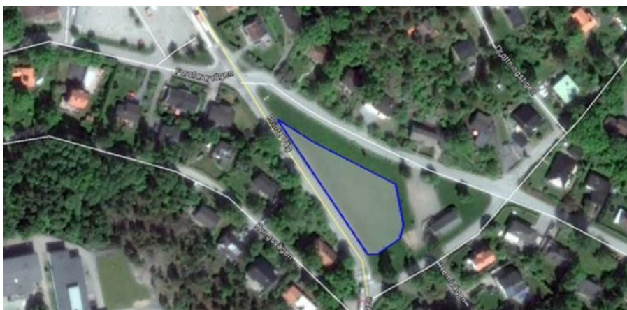
Figur 18. Illustration av ytbehov och ungefärlig placering av en dagvattendamm vid remivägen på 0,08 hektar (våtyta), vilket motsvarar cirka 1 % av avrinningsområdets reducerade yta.
